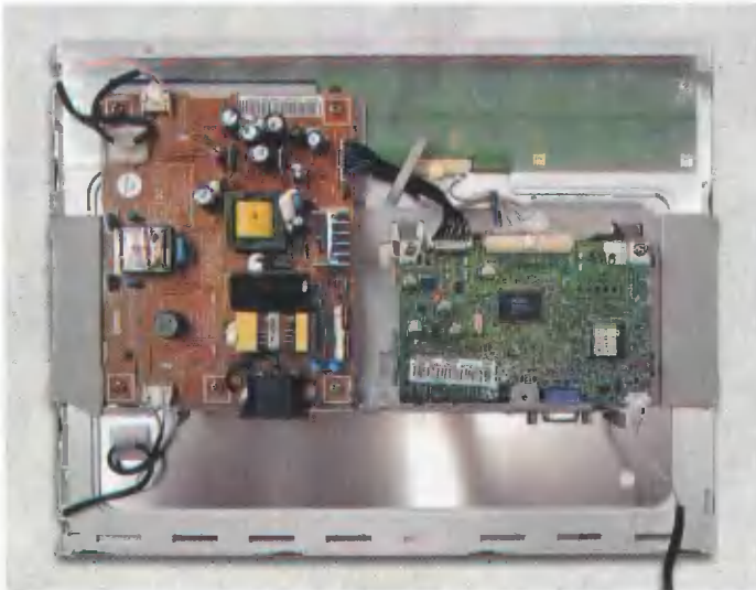
Снять с монитора крышку – это только половина дела. Дальше предстоит демонтировать блок управления и блок питания.
